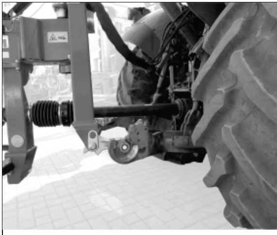
Fig. 21 les raccords de prise de force sont sur une hauteur identique
