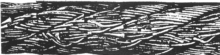
Figure 2 – Forte usure et très nombreuses ruptures de fils ayant entraîné la dépose immédiate (toronnage croisé)
