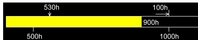
Fig. 1094: Wartungsintervalle - Wartungsintervall steht kurz bevor (leuchtet gelb)
