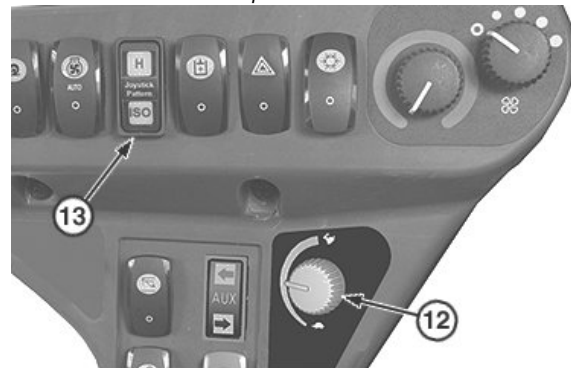
Cuadrante de control de régimen del motor e interruptor de selección de configuración
