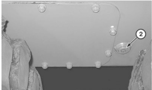
1— Tapón de vaciado (se usan 2) 2— Tapón de llenado (2)
