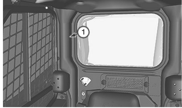
Ubicación de montaje del extintor de incendios
