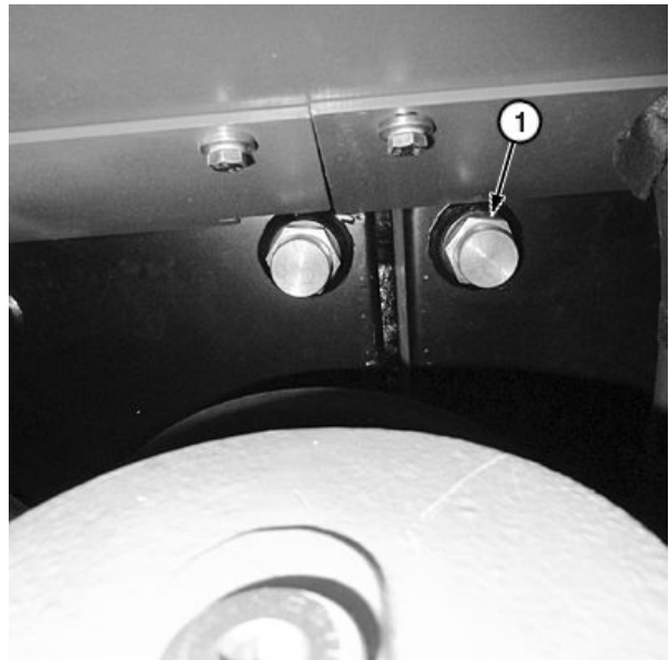
Vaciado del depósito de combustible
